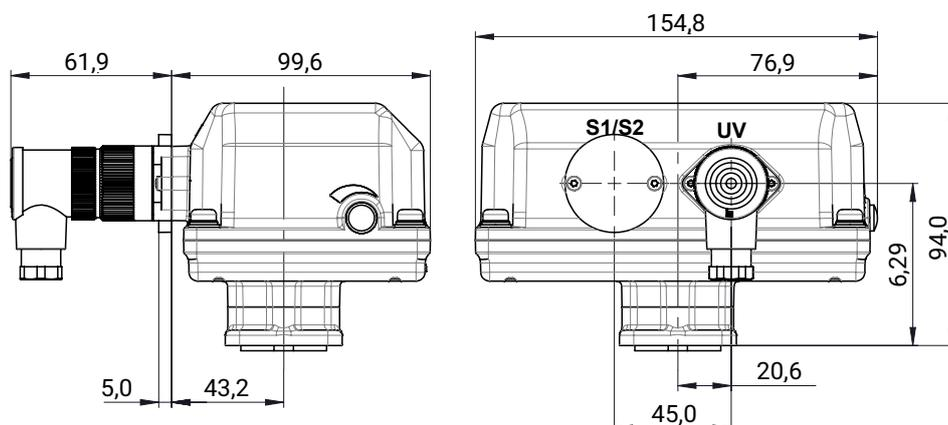
Commande Ouvert/Fermé, 2 contacts de fin de course à potentiel nul supplémentaires (module de régulation code AE)
