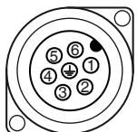
7-контактный штекер фирмы Binder, тип 693
