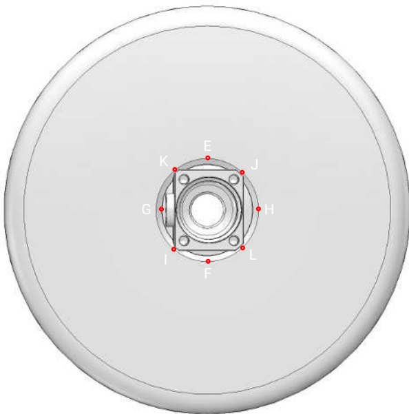
Außenansicht Behälter mit Heftpunkten
