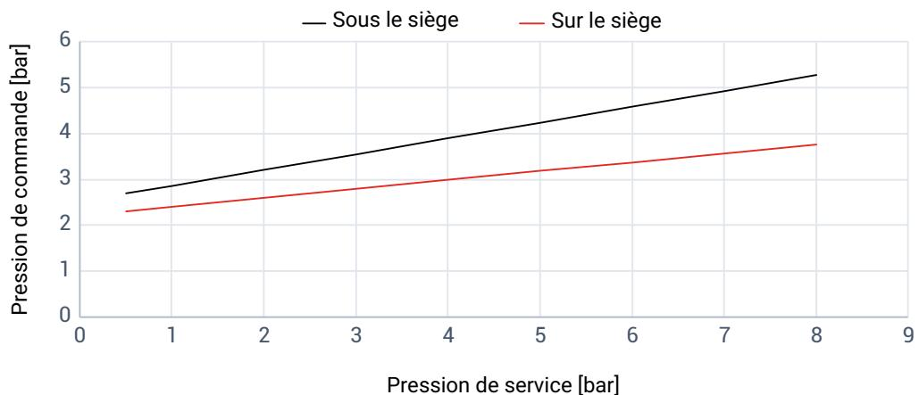
Courbe caractéristique Pression de commande - Pression de service, fonction de commande 2, F40, taille d'actionneur 4
