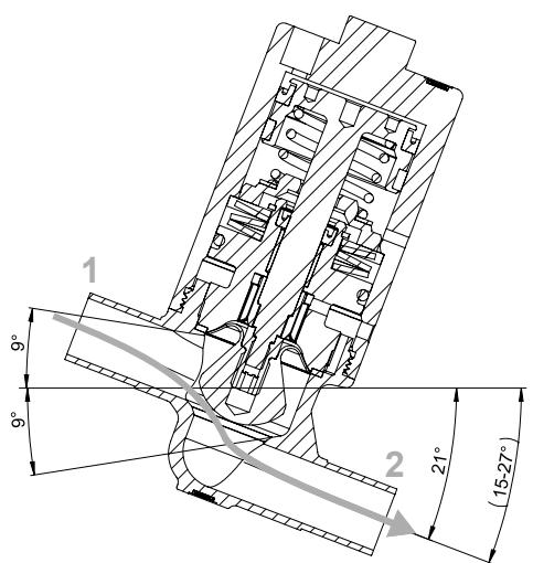
1 → 2, caractéristiques de fonctionnement optimales en vidange et en remplissage
