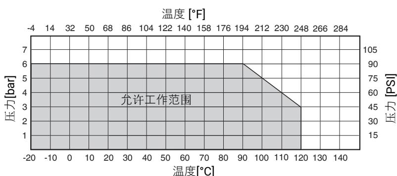
压力-温度图仅供参考。数据基于以水作为运行介质的情况。改变运行条件或使用其他介质有可能导致偏差。如有疑问, 请通过试装在规定运行条件下测试材料性能。
